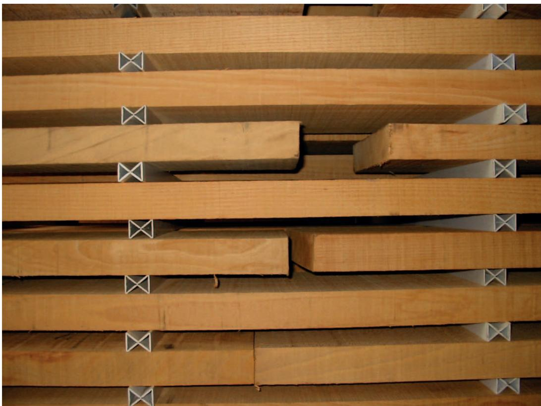
*Fig. 62 Exemple d'empilage correct.*
