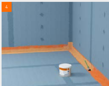
4 Immédiatement après qu'elle a été pressée, recouvrez la bande d'étanchéité d'une deuxième couche de membrane liquide fermacell™
