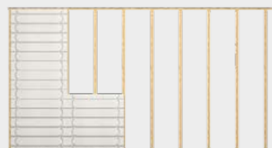
Montage des plaques de sol Therm25™ sur la sous-structure (vis de 40 mm ou agrafes de 50 mm)
