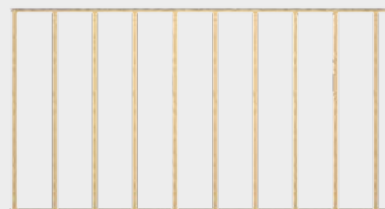
Entraxe de la sous-structure, max. 500 mm
