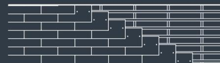
Pose inclinée à recouvrement double
