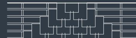
Pose horizontale à recouvrement double
