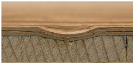
Parquet conventionnel à âme centrale en épicea (couche d'usure chêne 3,6 mm)
