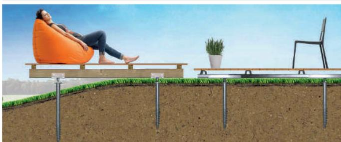
Une gamme de vis en inox de fondation développées pour différents types de sol et qui permet de s'adapter aux différences de niveau du terrain rapidement
