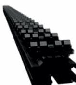
Rail autoportant pour la pose clipsée sur **PLOTS TOP LIFT**. A poser tous les 50 cm d'entraxe maximum.
